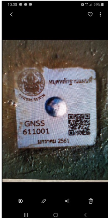
ภาพที่ 9 การสแกนใช้งานหมุดหลักฐาน QR Code
